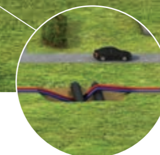
Fleksibilnost cijevi pri montaži
